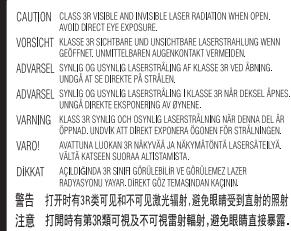
Deze sticker bevindt zich op de laserafscherming in de behuizing.
